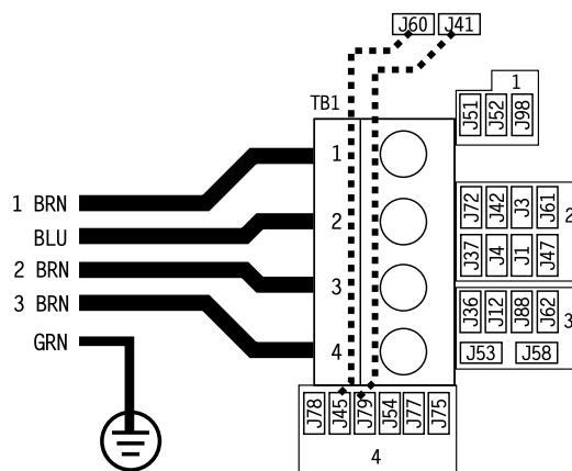
**Подключение к однофазной сети 220В, 32А (блок управления BP200G1)**
