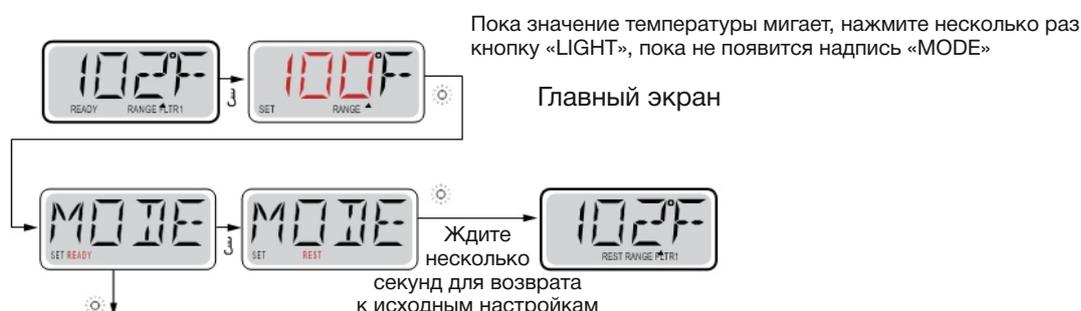
На дисплее начнет отображаться «READY/REST», если спа-бассейн сначала находился в режиме «REST», а после была нажата кнопка «JETS 1». Предполагается, что спа-бассейн используется, и он будет нагрет до установленной температуры. Можно включать и выключать насос 1, но циркуляционный насос будет работать постоянно, пока не будет достигнута заданная температура или не пройдет 1 час. После 1 часа работы спа-бассейн вернется в режим «REST».
