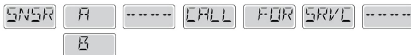
Неисправность датчика температуры или в цепи датчика. Обратитесь в сервисную службу.
