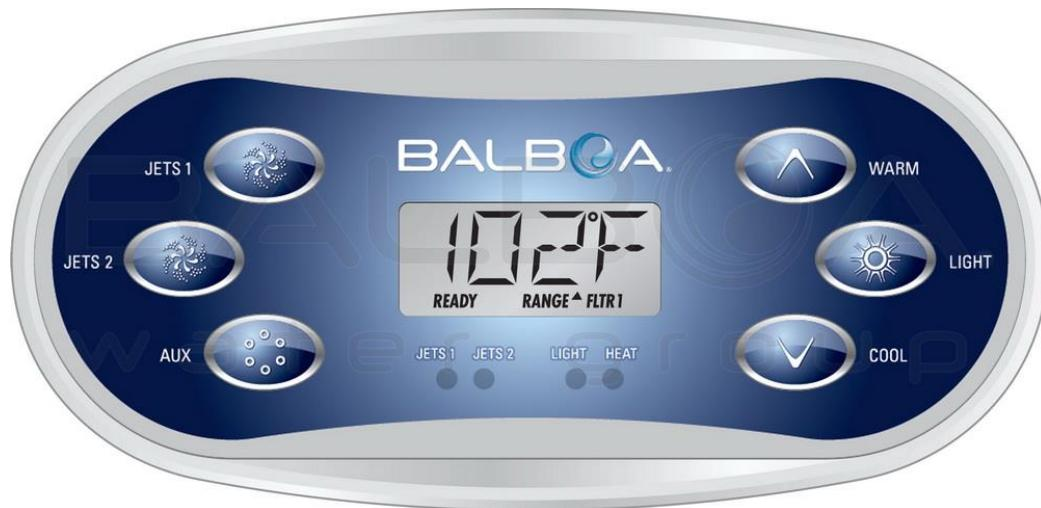
Слева кнопки: Насос 1 (JETS1), Насос 2 (JETS 2), Аэронасос (AUX)
